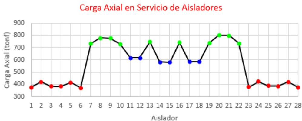
Figura V-4: Carga axial de servicio de cada aislador.
