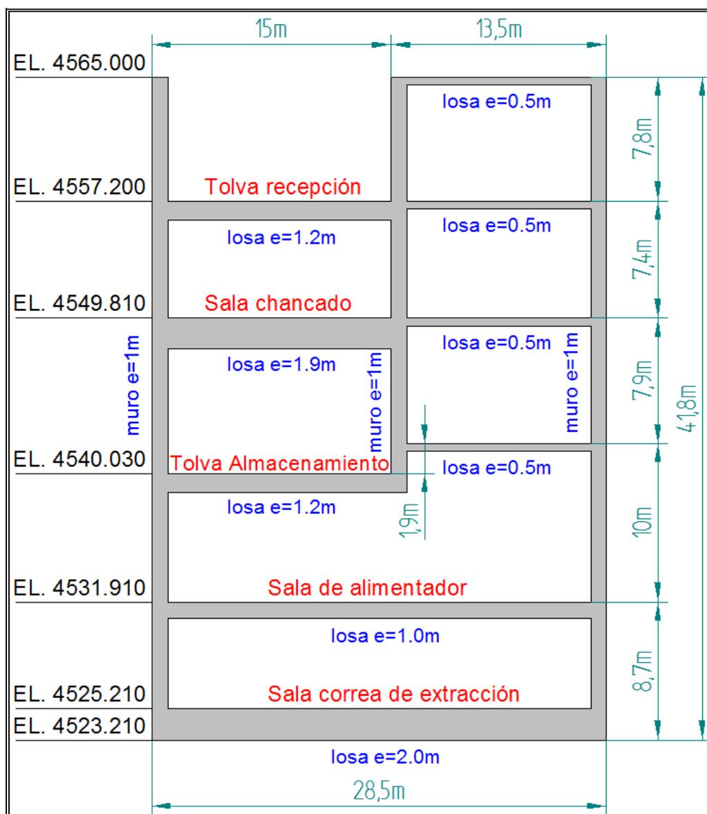
Figura II-2: Sección del layout del edificio Chancador Primario - dimensiones
