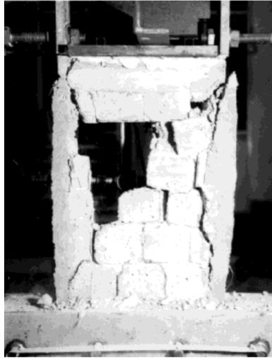
Figura 4.8: Falla típica por agrietamiento diagonal de los muros ensayados [10].
