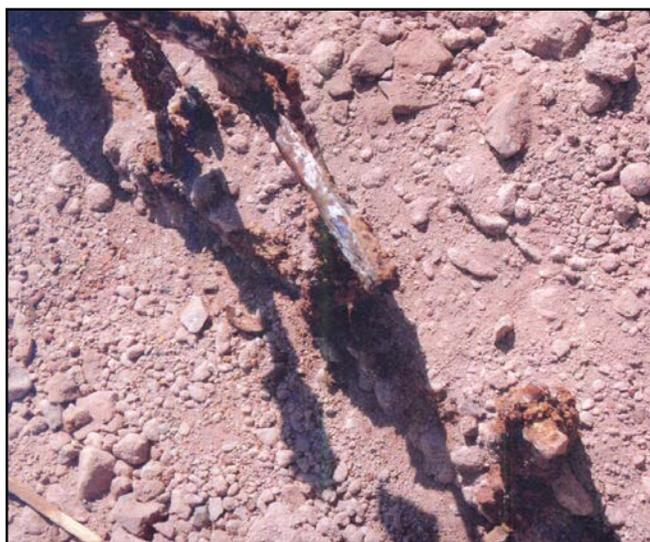
Figura 2-7: Falla tirantes de acero. Muros mecánicamente estabilizados. Dm 43.960 m.
