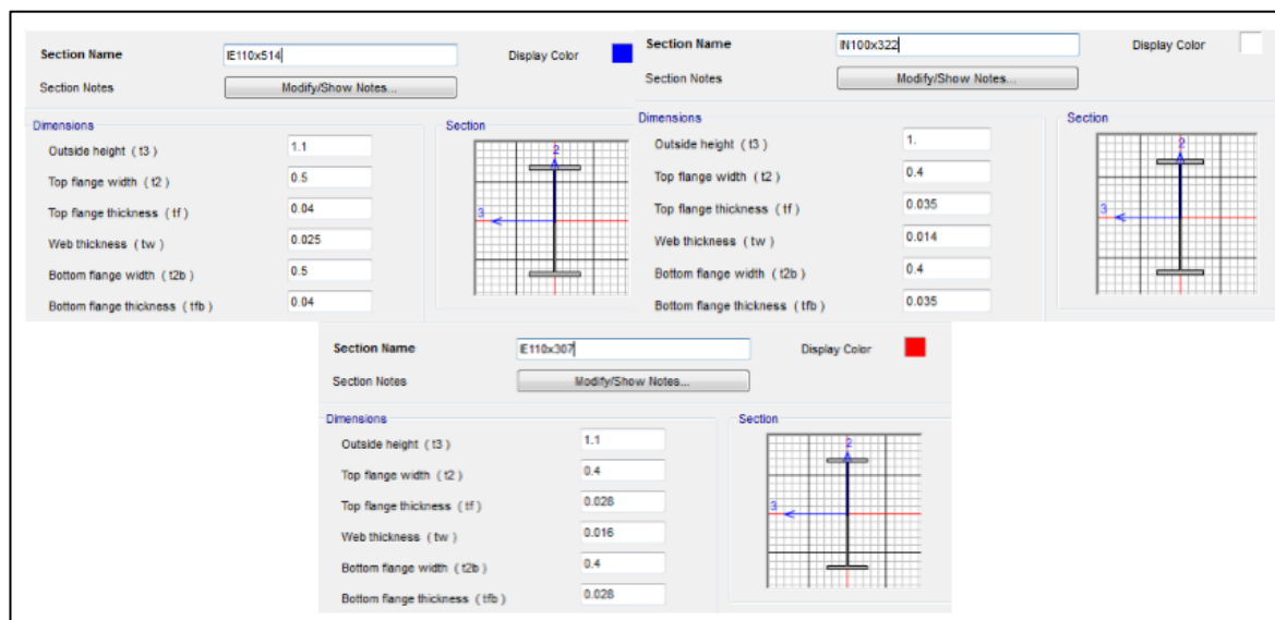
Figura III-14: Secciones de vigas (metros).
