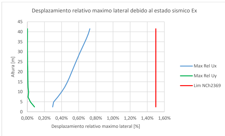
Figura VI.6.7.b Serviciabilidad: Desplazamiento relativo máximo lateral debido al estado sísmico [elaboración propia]
