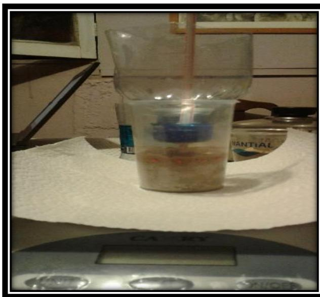
Figura II-6: Dispositivo de expansión casero
