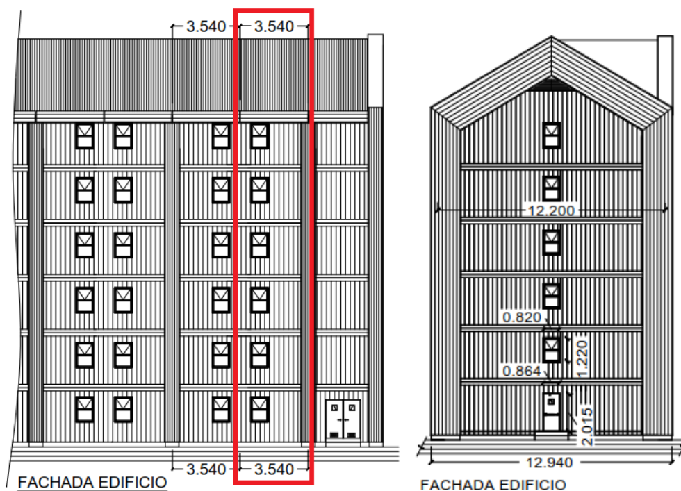
Figura II-1: Fachadas del Edificio Modular Prefabricado Proyectado (Unidades en milímetros).
