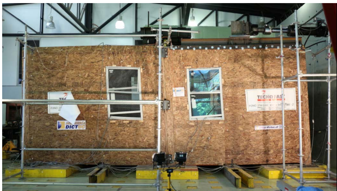
Figura VI-79: Módulos durante el ensayo – Desplazamiento Global del +6% y Drift del 3.9%.
