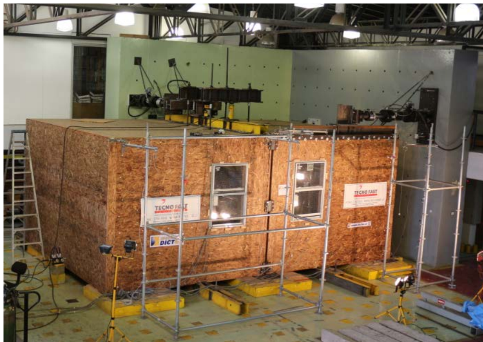
Figura III-59: Vista General del Ensayo a Full Escala en 3-Dimensiones de unidades modulares prefabricadas.
