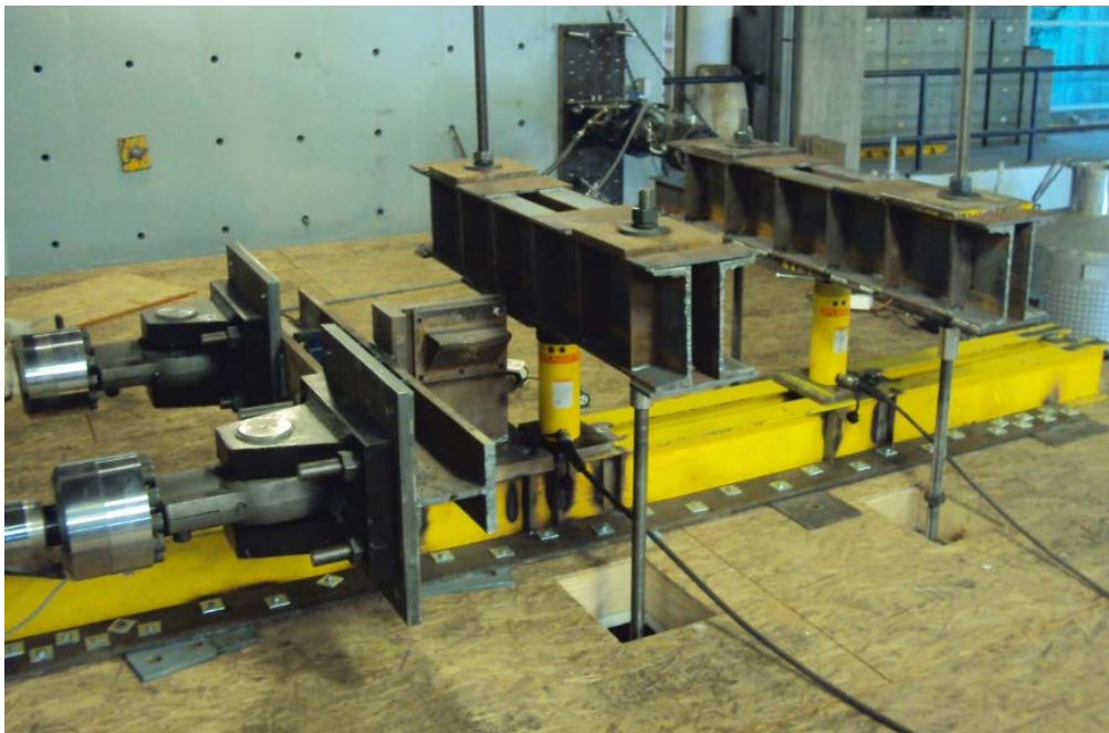
Figura III-60: Vista sentido Longitudinal, se aprecian actuadores horizontales, gatos hidráulicos de aplicación de carga axial y vigas de reacción y distribución de carga vertical.
