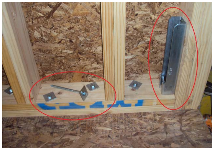
Figura III-29: Vista Lateral del muro probeta (Sup) donde se aprecian los conectores Hold-Down y un acercamiento del detalle de su punto de instalación (Inf), también se observa el tirafondo utilizado para conectar muro con la losa de piso (Inf).
