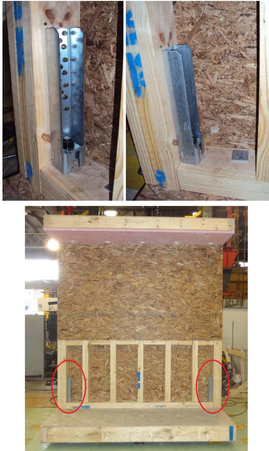
Figura II-6: Dispositivo Hold-Down HDQ8 ubicado en muro de ensayo.
