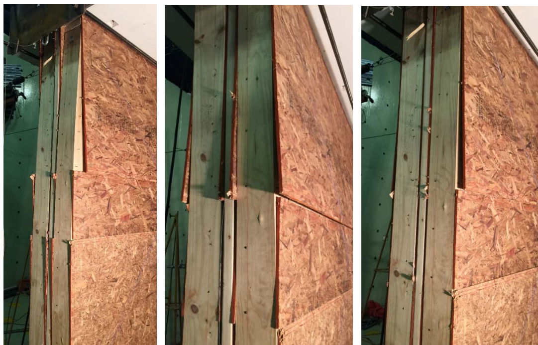
Figura IV-72: Vista Frontales de Probeta Muro No. 2 deformada evidenciando el modo de falla pull through entre revestimiento y Pie Derecho.
