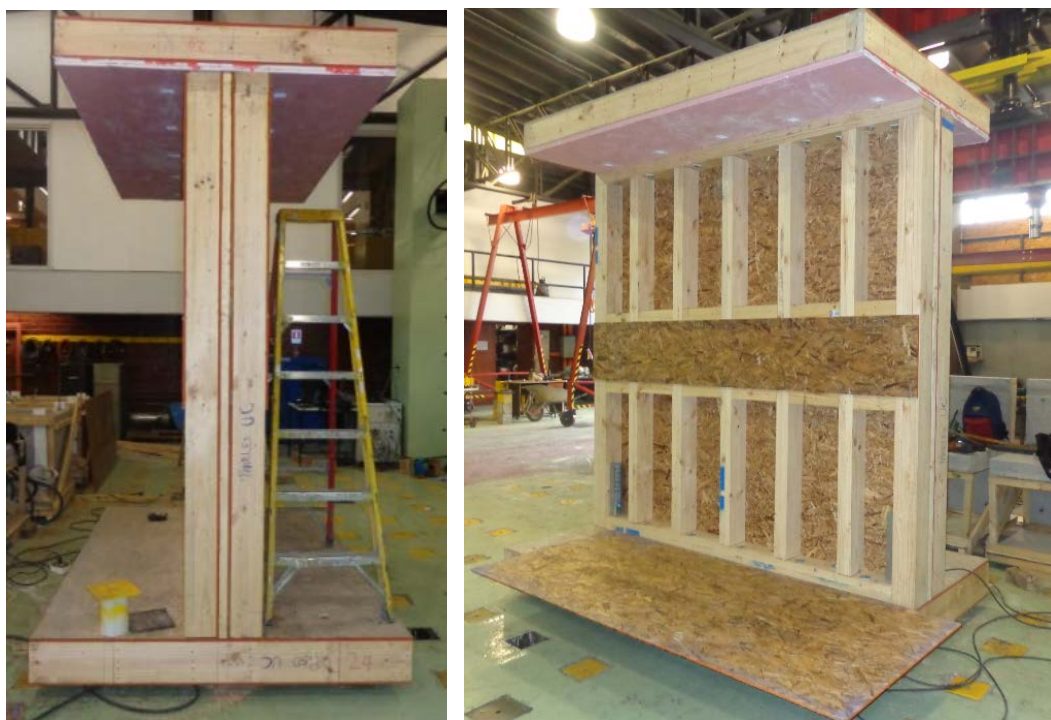
Figura III-27: Vista Frontal (Izq.) y lateral (Der) de la probeta de ensayo, se aprecia panel doble de muro y paneles superior e inferior que representan a la losa de cielo y la losa piso.
