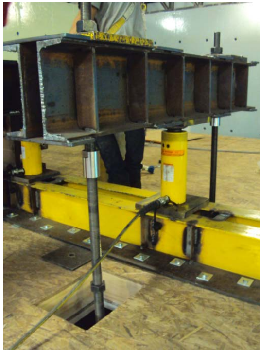
Figura III-61: Gatos hidráulicos y vigas de reacción.
