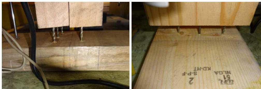
Figura II-10: Conexión Clavo con eje longitudinal hincado en el eje longitudinal del Pie Derecho durante el ensayo de extracción directa por tracción.
