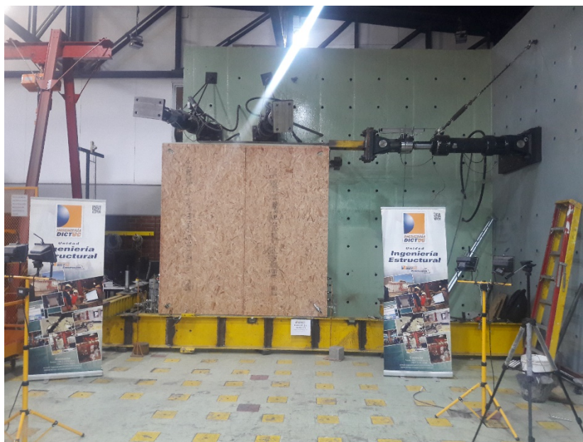
Figura IV-87: Vista Lateral del Muro No. 3 con ubicación de actuador para aplicar las cargas cíclicas.
