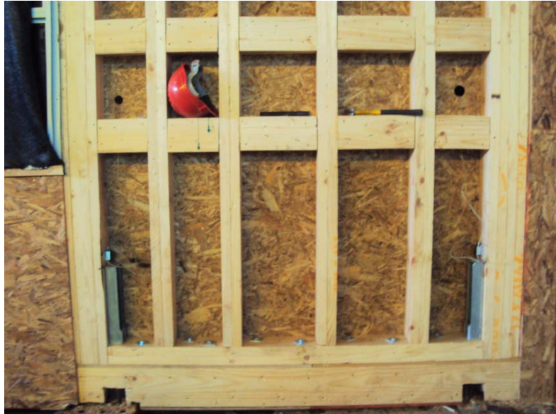
Figura III-66: Medición de deformaciones relativas entre Pie Derecho y Conector Hold-Down.
