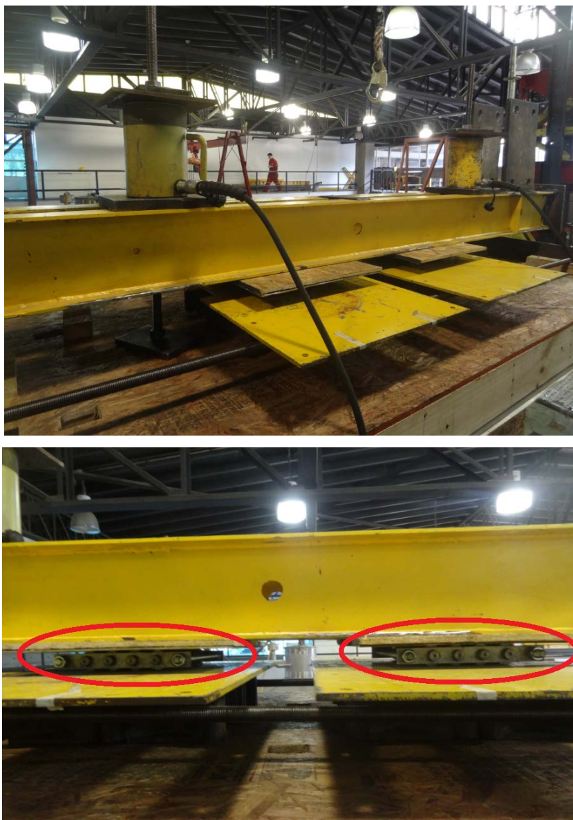
Figura III-55: Vistas superiores laterales del Muro No. 2 con detalle en rodillos bajo viga doble de distribución de carga axial.
