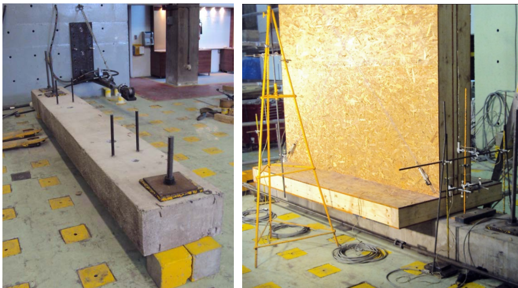
Figura III-50: (Izq) Barras de anclaje de conector Hold-Down HDQ8 instaladas en su posición. (Der) Probeta de Muro No. 2 conformada y colocada en su ubicación definitiva de la base de hormigón momentos antes del ensayo.
