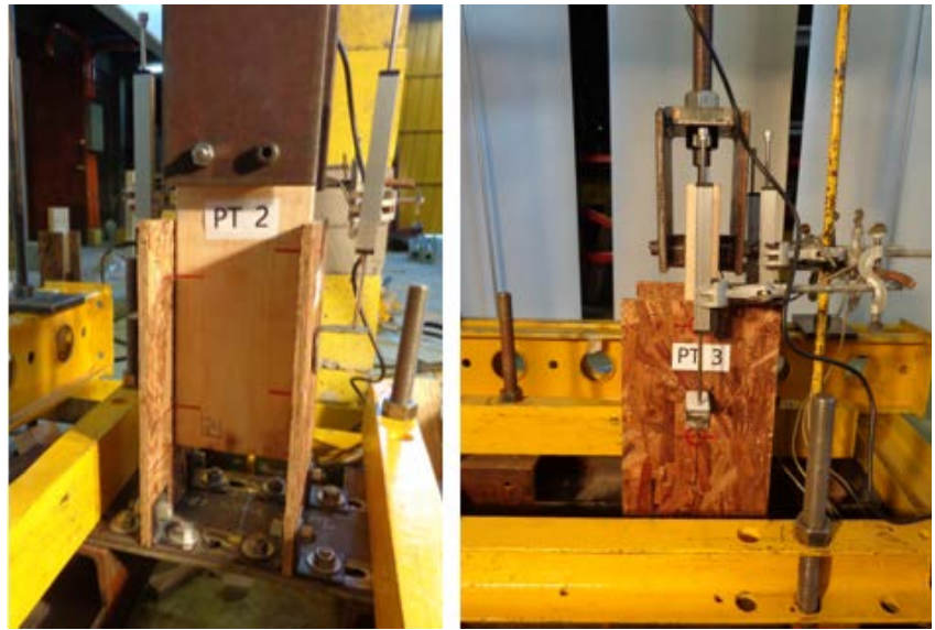
Figura II-12: Ensayo Cíclico de Cizalle Representando Conexión Clavada entre: Pies Derechos – Tablero de OSB.
