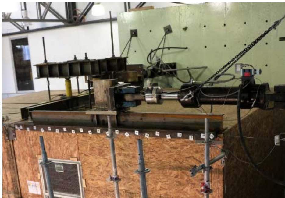
Figura III-64: Vista sentido Transversal, se aprecia actuador y viga de transferencia de corte entre actuador y probeta.
