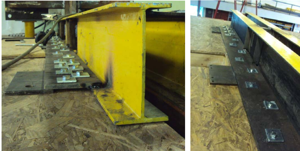
Figura III-63: Detalle de transferencia de corte entre sistema de vigas de distribución y losa de cielo de probetas modulares, la conexión se materializa mediante tirafondos de \phi 1/2'' \times 8'' .
