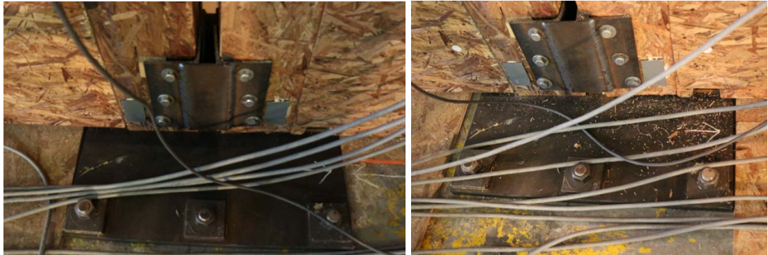
Figura IV-84: Antes y Después, efectos de amortiguamiento y disipación de energía (Base compartida entre Módulos Norte y Sur).
