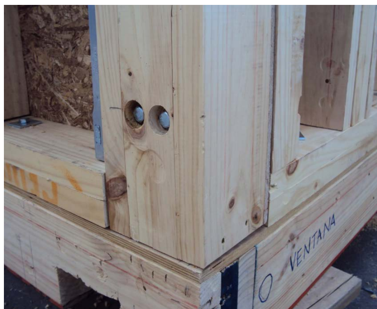
Figura III-43: Detalle de conexión entre muros perimetrales longitudinal y transversal de Módulos en ensayo 3D (unidades en milímetros).
