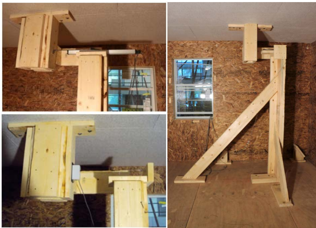
Figura III-65: Medición de deformaciones horizontales relativas entre losas de cielo y piso dentro de los módulos, (Izq: Módulo Norte; Der: Módulo Sur).
