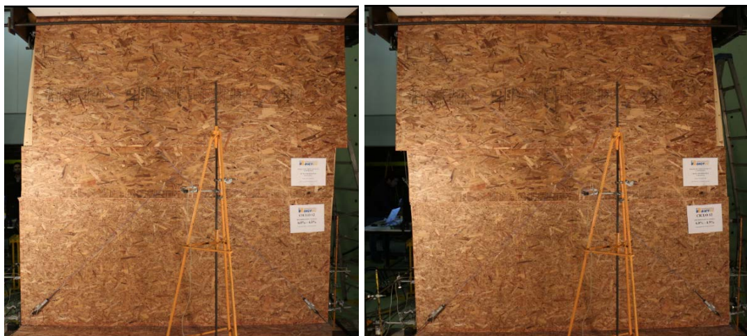
Figura IV-71: Vista Lateral de Probeta Muro No. 2 deformada a un desplazamiento global del 6% (146.4mm).
