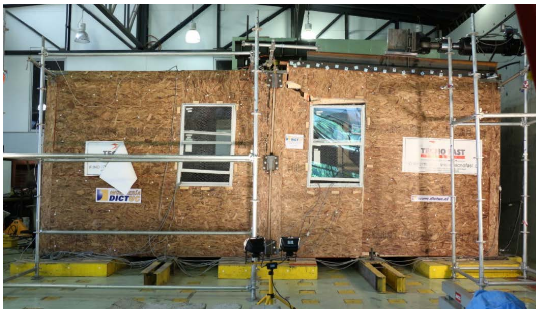
Figura IV-80: Módulos durante el ensayo – Desplazamiento Global del -6% y Drift del 3.9%.
