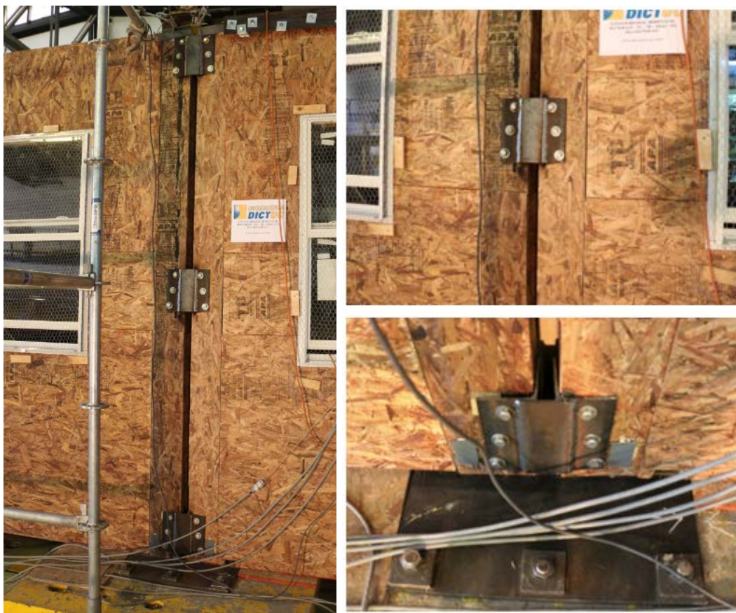
Figura III-47: Conectores rígidos entre muros del sentido transversal.
