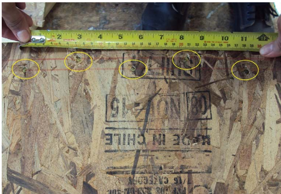
Figura III-36: Muro Transversal con clavos escalonados cada 70mm.
