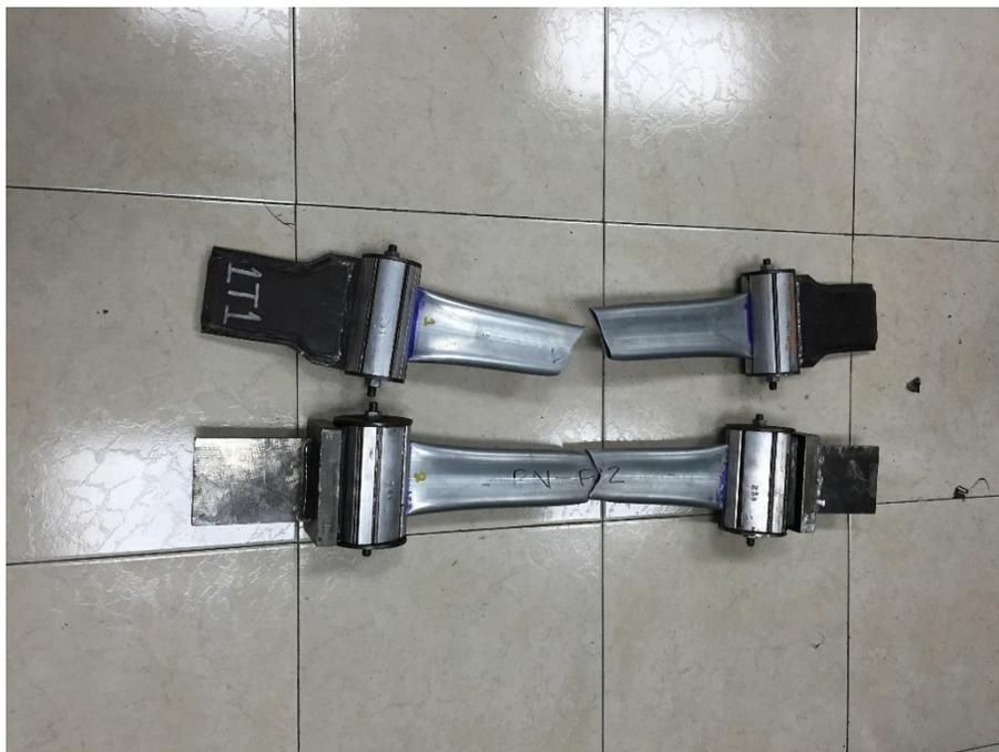
Figura IV-3: Probeta post ensayo de tracción. (ENEL, 2015).
