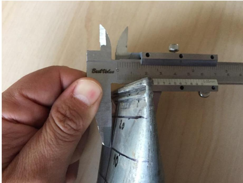
Figura III-9: Medición lateral elemento real espécimen 4.
