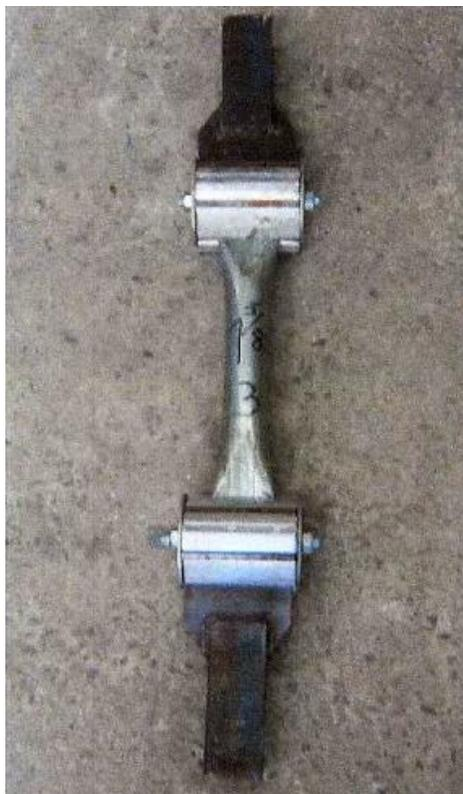
Figura IV-8: Montaje de probeta para ensayo real (ENEL, 2015).
