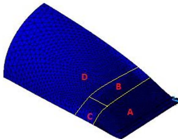
Figura III-14: Subdivisión del elemento mallado.
