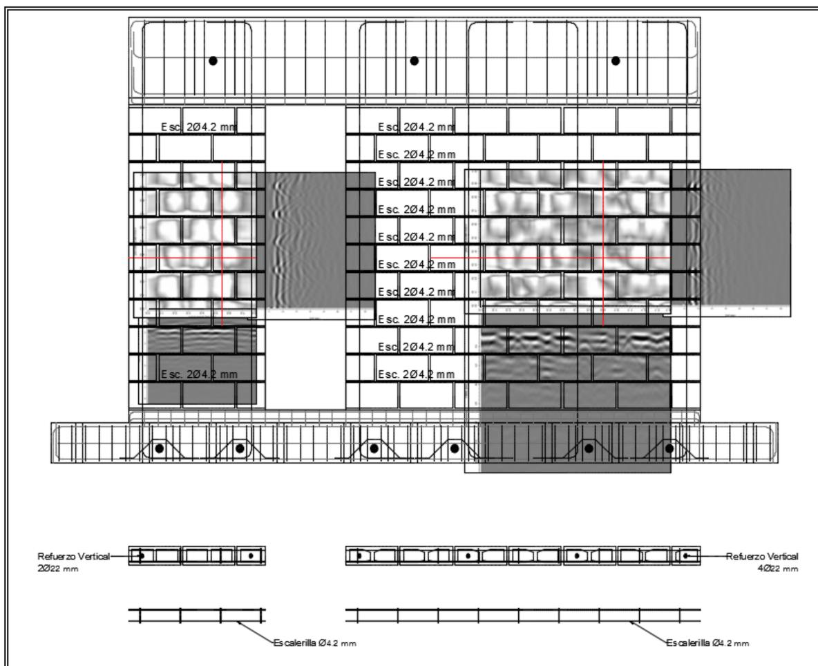
Figura III-14: Elevación estructural de muro y superposición de resultado de imagen de radar de ensayo con GPR.
