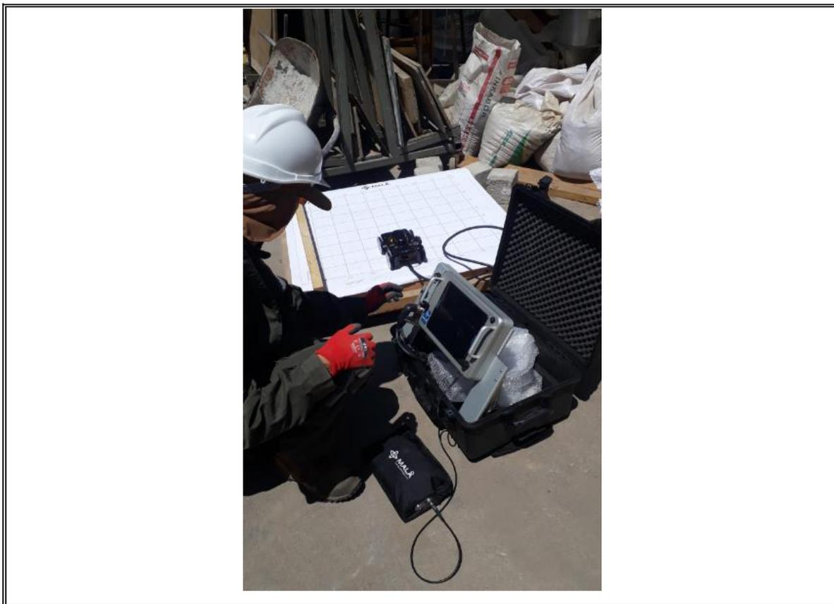
Figura III-1: Imagen de componentes que conforman el equipo MALA CX.
