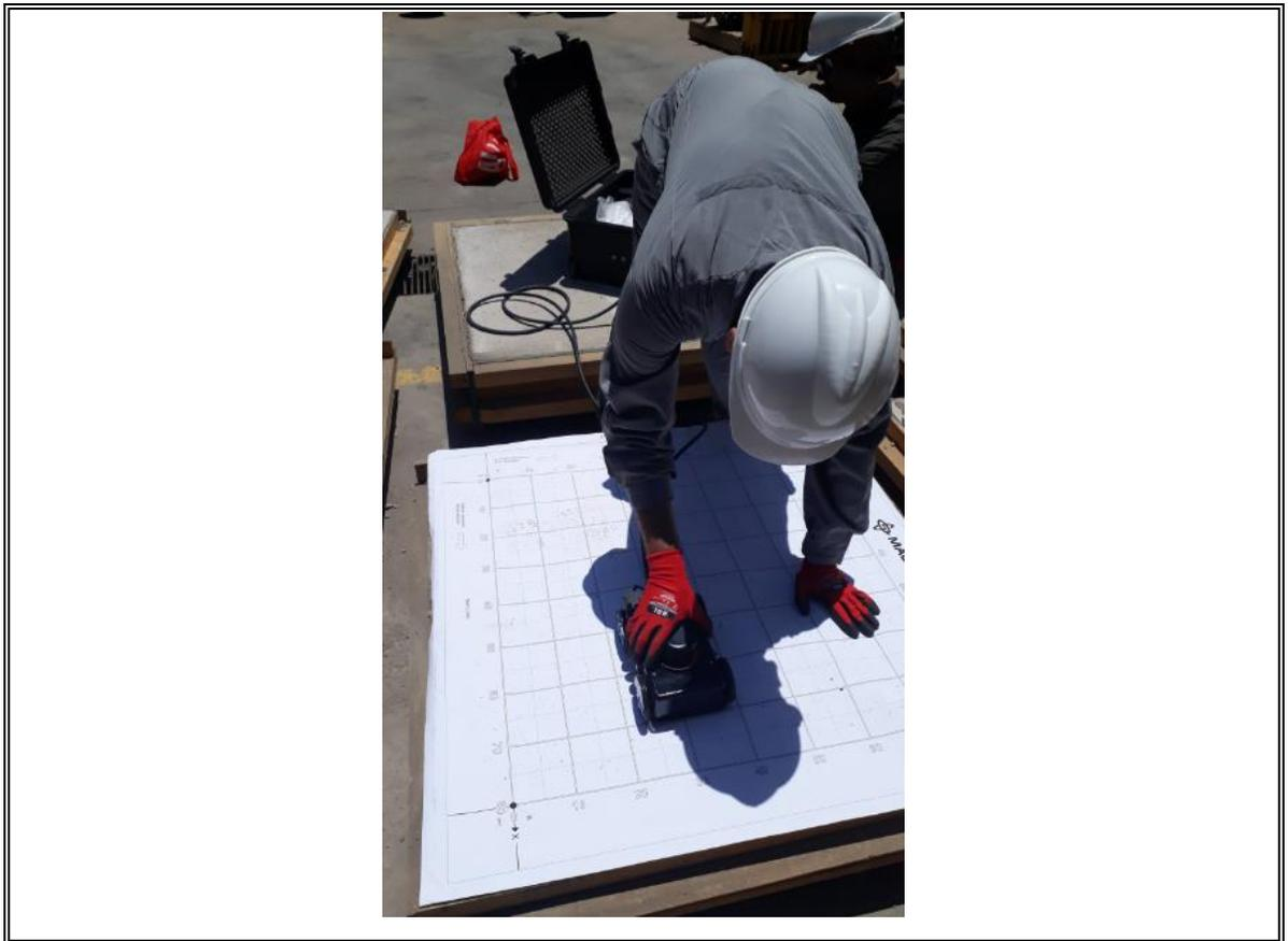
Figura III-3: Imagen de desplazamiento de la antena y toma de lecturas.
