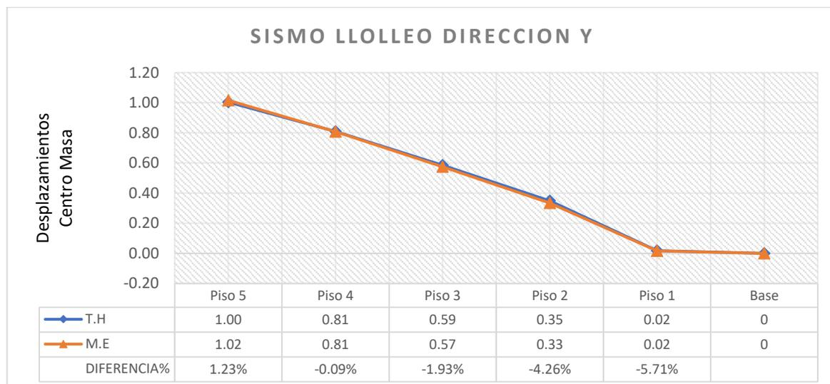
Figura 4-52: Desplazamiento Centro Masa-Sismo Lollole dirección Y
