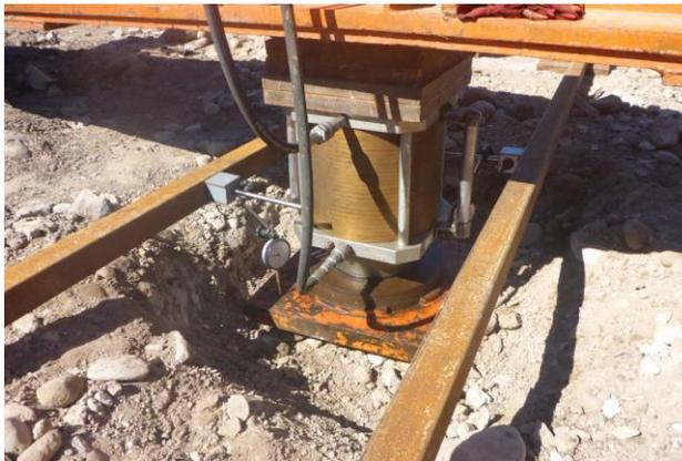
Figura VII-13 Vista del montaje de los comparadores sobre el pilote de prueba.
