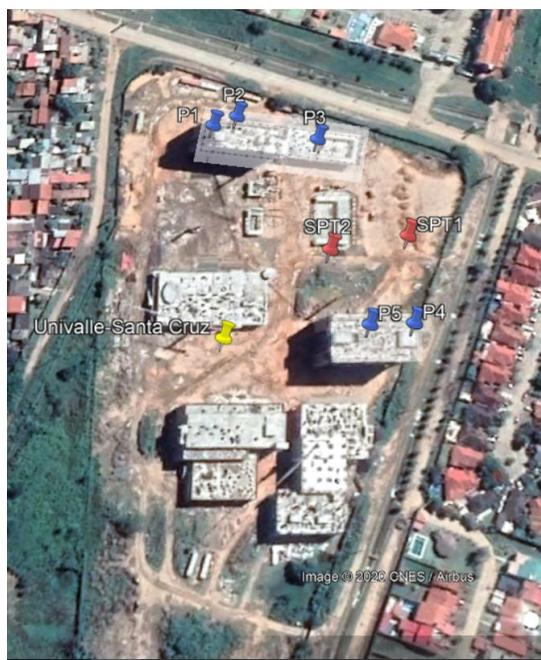
Figura VII-2 Ubicación de los ensayos SPT y los pilotes de prueba en la zona de estudio (Google Earth).
